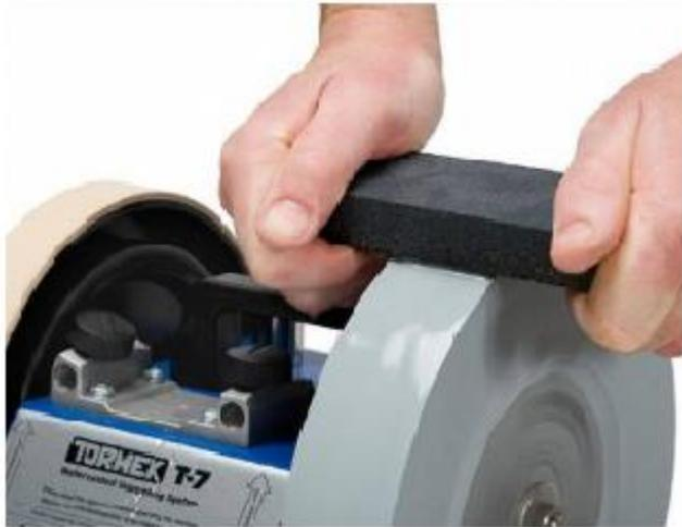
**Брусок SP-650** предназначен для придания заточному кругу Tormek фактуры разной зернистости. Используя грубую сторону бруска SP-650 получаем фактуру 220 Грит для черновых операций. Используя тонкую сторону бруска SP-650 получаем фактуру 1000 Грит для чистовых операций.
