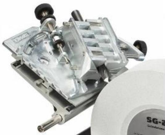
**Держатель DBS-22** подходит для заточки сверл диаметром от 3 мм до 22 мм, углом резания от 90 до 150 градусов и задним углом до 7 градусов, 9, 11, 14 градусов на станке Tormek.
